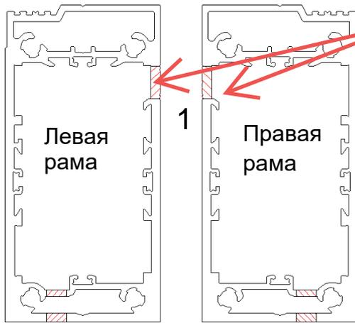
1 – Фрезеровка под подвижное стекло -Пример расчета
